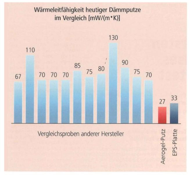
Vergleich von aktuellen Dämmputzen mit dem neu entwickelten Aerogel-Putz: Das Material isoliert vergleichbar gut wie eine EPS-Platte (EPS = Extrudiertes Polystyrol). (Bild: Empa)
